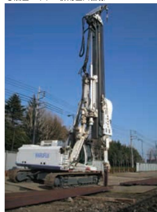
打設アタッチメントを交換することにより、通常の削孔注入工法も可能です。
