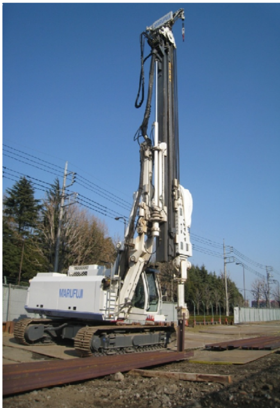
▲ RG杭打機 油圧パイプロ併用圧入仕様
